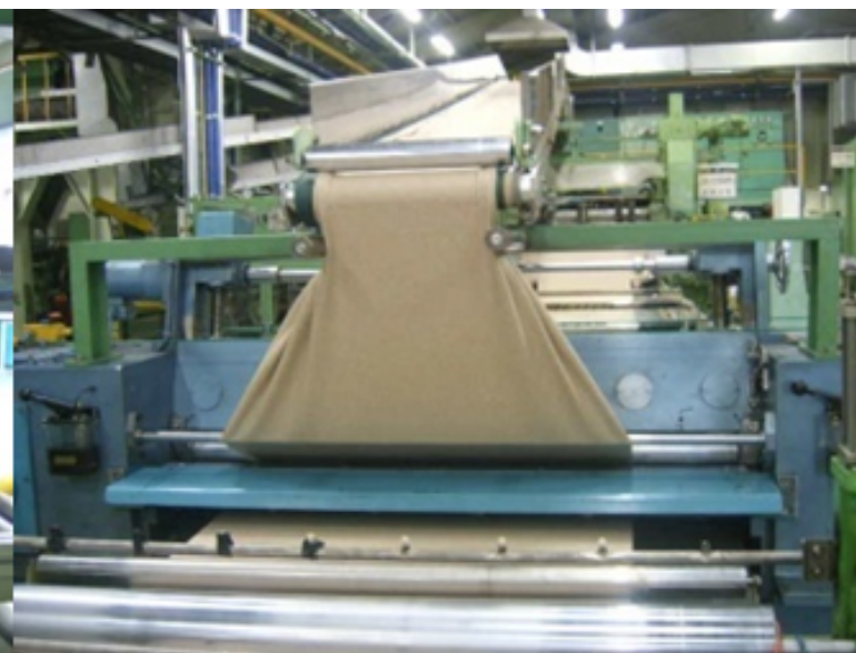
○ CHIP 제품류의 표면을 구현하기 위해 고무 SHEET의 표면을 벗겨내는 라인
