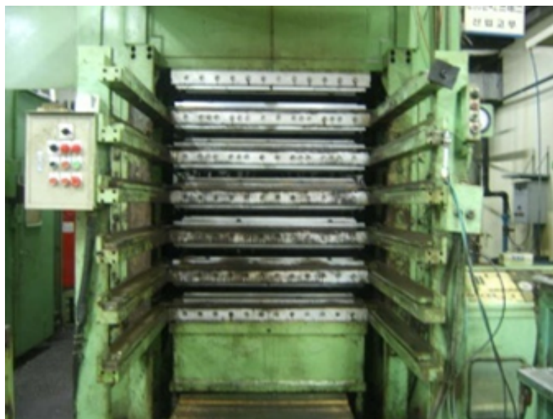
○ 고무 SHEET를 가교, 성형하는 라인
