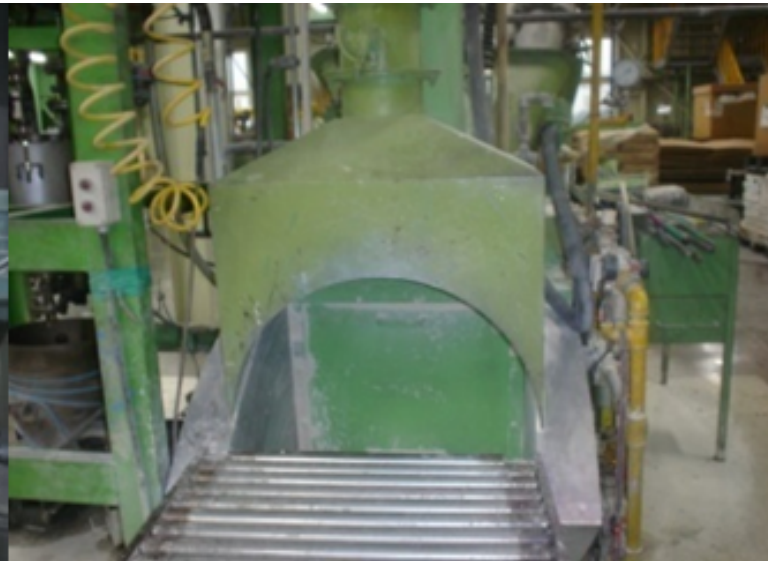
○ 계량된 원료와 수동 계량 및 소량 자동 계량된 원재료를 내부 2개의 스크류로 믹싱하는 라인
