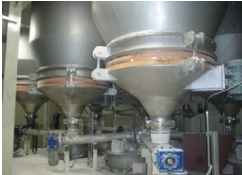
○ 고무타일의 원료 분진을 전자식 저울로 계량하여 반바리 믹서로 송출하는 라인
