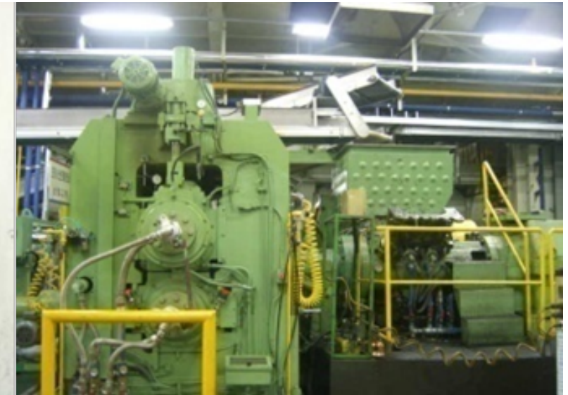
○ COMPOUND를 재 혼련하여 2ROLL에서 압착 가능한 두께로 가공하는 라인
